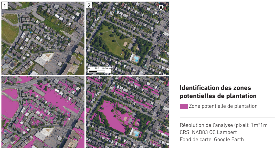
Figure 3. Illustration de l'identification des zones potentielles de plantation dans les arrondissements de Saint-Léonard (1) et Rosemont-La-Petite-Patrie (2). Les images du haut permettent de localiser le territoire alors que les images du bas présentent la couche géomatique regroupant les zones non minéralisées où la plantation d'arbres est possible selon les critères utilisés.
